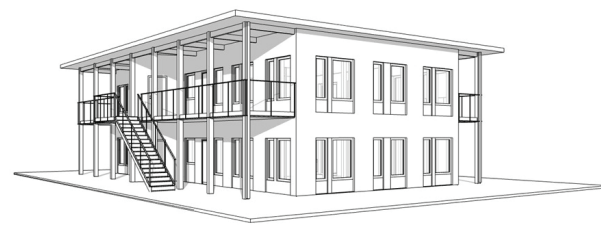
Platt tak med överhäng och takfot med överhäng, taket går över balkongerna.
