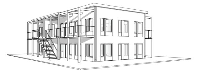
Valmat tak med minimal lutning, med överhäng. Utan pergola men med skärmtak över entrén.
