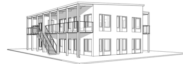
Pulpettak med 5 graders lutning, utan tak över balkonger.
