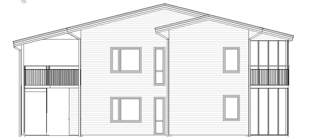
Fasad mot nordost, originalhus, A-ritning Efem arkitekter. Fasad: Målad träpanel.
